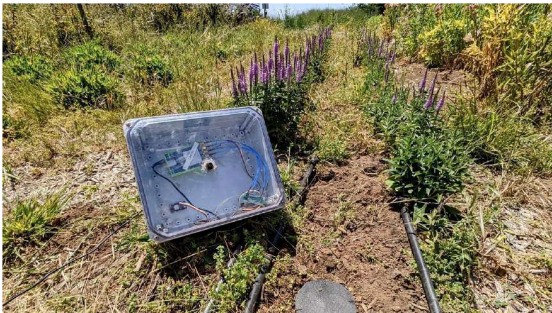
Celda de combustible microbiana de suelo lista para su despliegue. / Universidad de California-Santa Cruz
