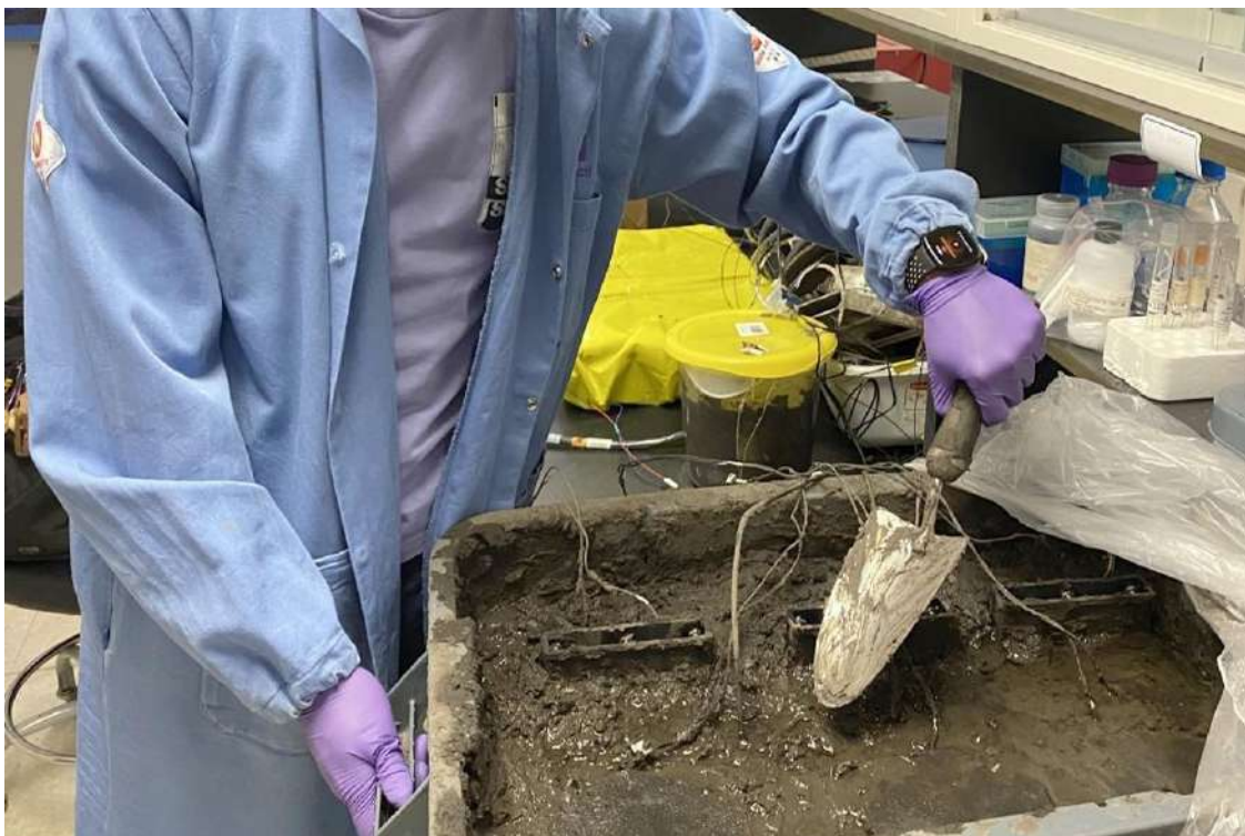
Un investigador trabaja en el laboratorio enterrando una pila de combustible en la tierra. / Northwestern University
